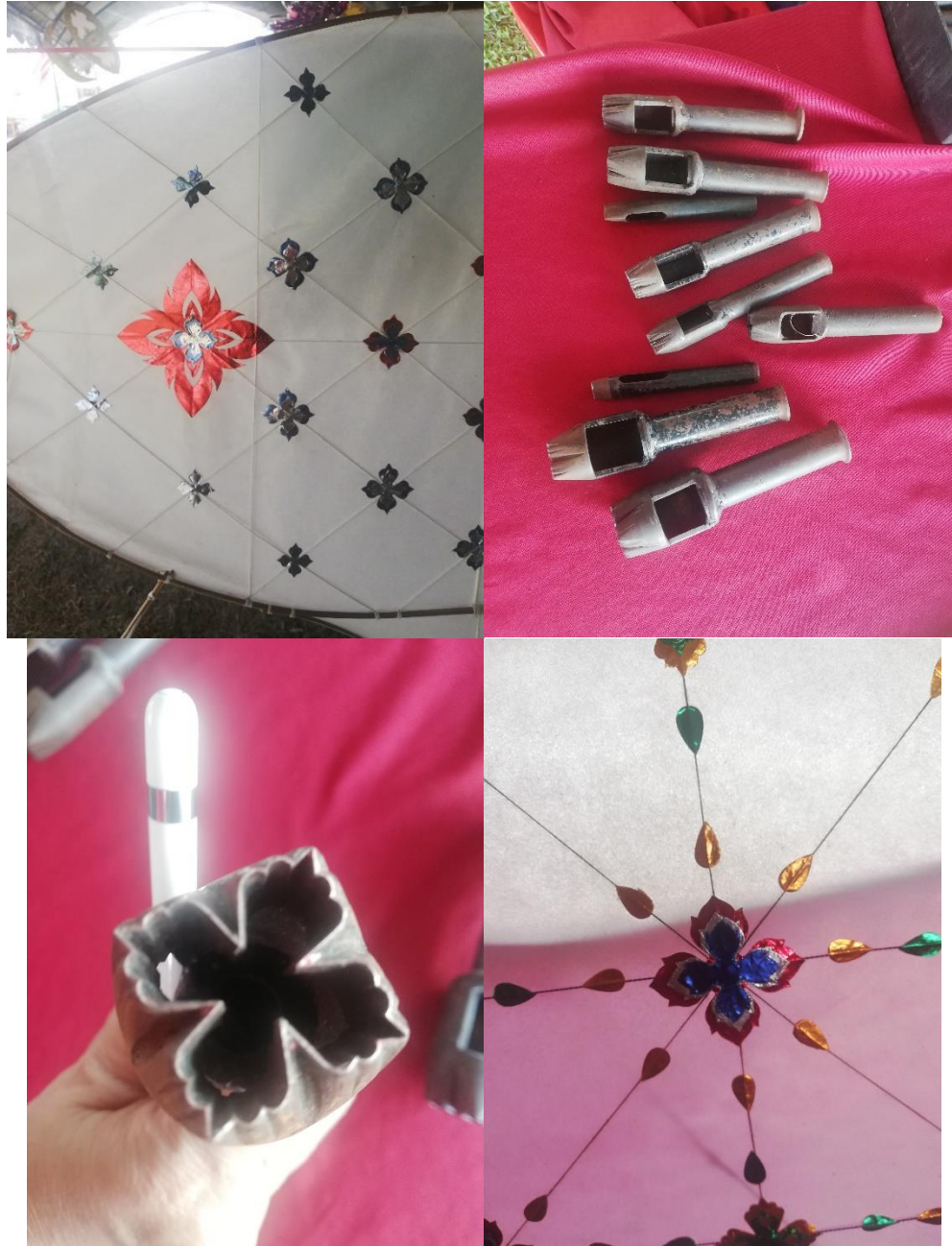
ภาพที่ 4 ลวดลายบนตัวว่าวเป็นลายดอกไม้นี้มีสีสันทาจากกระดาษแก้วโดยการสังทำบล็อกเหล็กเพื่อใช้ ดอกเหมือนตุ้ตู่แทนการตัดด้วยกรรไกร ที่มา: ถ่ายโดยผู้ช่วยวิจัย วันที่ 21 ธันวาคม 2563
